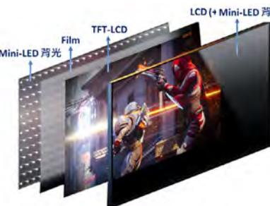
LCD 搭配 Mini-LED 背光示意圖
