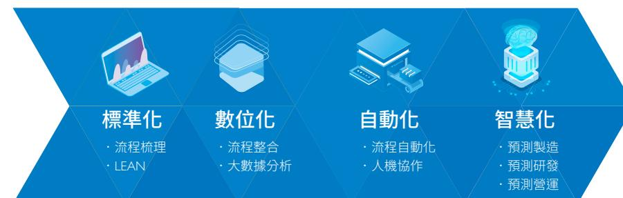
首先為標準化，以精實 (LEAN) 進行流程梳理；接著進入數位化，經由感測器透過物聯網將所有數據進行數位化並整合到大數據平台進行分析、整合；再來是自動化，包含流程自動化以及人機協作相關應用；最後是智慧化，包括預測製造、預測研發以及預測營運。
